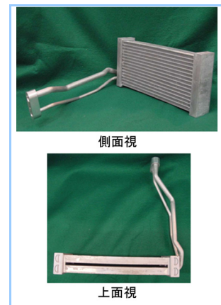
図7 暖房用車内凝縮器
